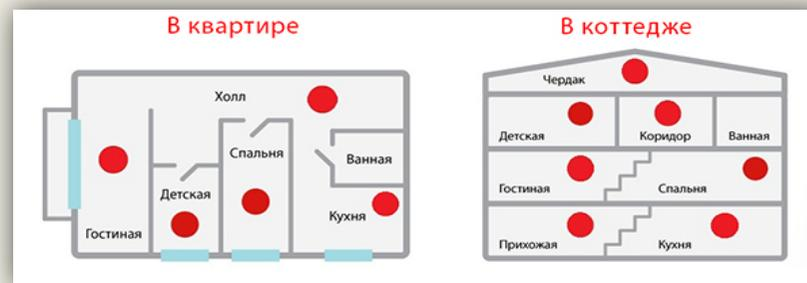
При монтаже расстояние от датчика до осветительного теплоизлучающего прибора должно быть не менее 0,5 м, до вентиляции не менее 1 м. Как правило прибор монтируется в центре потолка либо у стены но не ближе 10 см. Если датчик расположен на стене, то расстояние до потолка должно быть 10 – 30 см, вместе с габаритами самого прибора.
